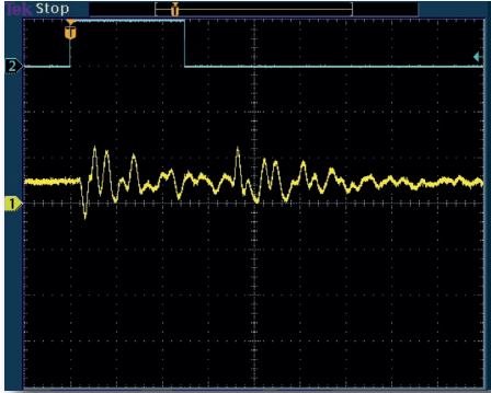
MAGNETVENTIL: Messung mit Gummifüßen.
